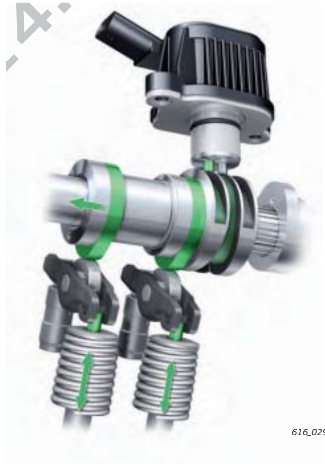
凸轮块被推回到正常工作状态 4缸模式
